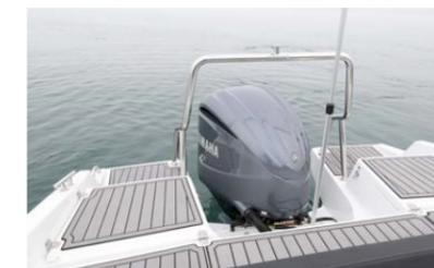
Le Yamarin Cross 75 BR est homologué pour une motorisation hors-bord de 300 cv au maximum. Un concentré de puissance que le 75 BR a démontré qu'il savait gérer lors du test avec un Yamaha F300. La vitesse de pointe était de plus de 90 km/h, sans jamais avoir l'impression que le bateau était surmotorisé. Cela dit, 200 cv seraient probablement suffisants...
