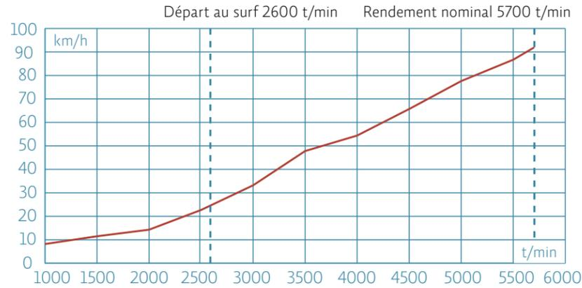
Point mort: 600 t/min, Vitesse maximale: 91,9 km/h pour 5700 t/min. Mesuré sur le lac de Thoune, avec GPS, 2 personnes à bord, aucun vent et aucune vague.
