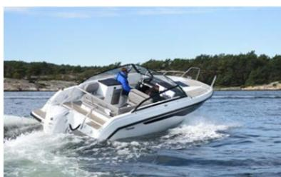
Der V-förmige Rumpf mit zwei Kimmkanten, dazu automatisch arbeitende Trimmklappen – das Boot zieht auf allen Kursen und bei allen Geschwindigkeiten stabil durchs Wasser. Und dies bei uneingeschränkter Übersicht, ob am Steuer sitzend oder stehend. Die elektrische Steuerung arbeitet fein und präzise, sie liesse sich mit dem neuen Yamaha HelmMaster EX ergänzen.
